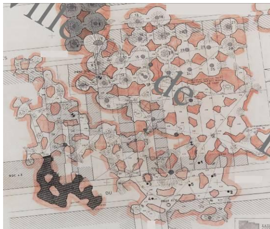
Plan d'une exploitation mixte (en bas à gauche chambres et piliers, en haut à droite catiches)
