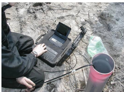
Inspection par caméra vidéo à travers un forage
